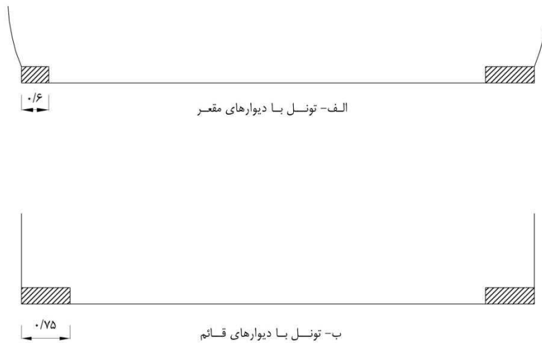
شکل ۶-۲۲- عرض پیاده‌روها با دیوارهای مختلف تونل
