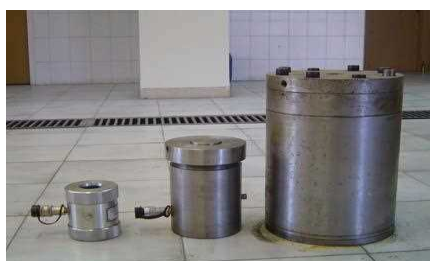
شکل ۳-۳- سلول هوک جهت انجام آزمایش مقاومت فشاری سه محوری
