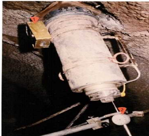
شکل ۷-۲- تصویر آزمایش کشش راک بولت
