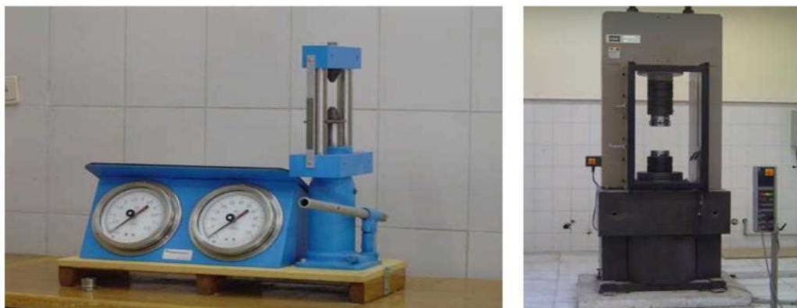
شکل ۱-۳- دستگاه MTS (سمت راست)، دستگاه آزمایش بار نقطه‌ای (سمت چپ)
