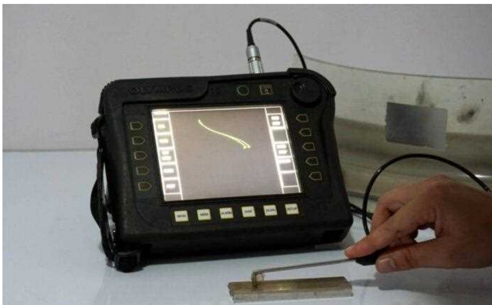
شکل ۲۱- دستگاه پرتابل التراسونیک شناسایی درز و ترک و خرابی های جوشکاری (Portable Ultrasonic flaw Detector)
