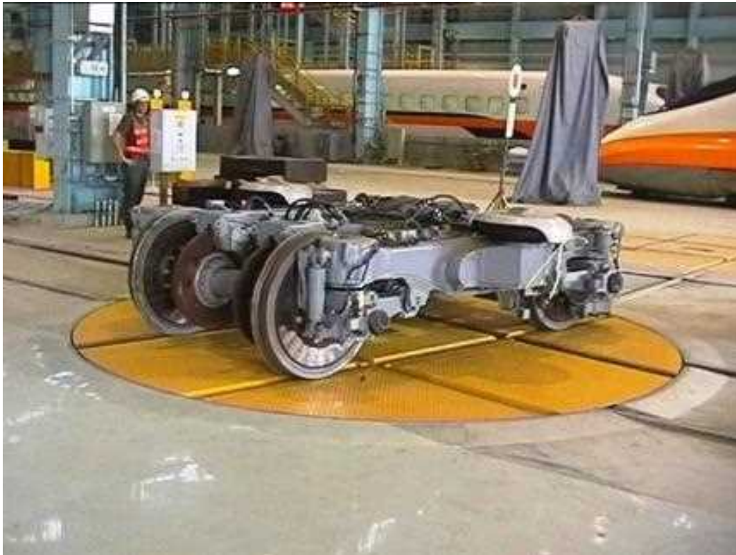
شکل ۷-۰ تصویر گرداننده بوژی از تجهیزات ثابت قابل نصب در فونداسیون
