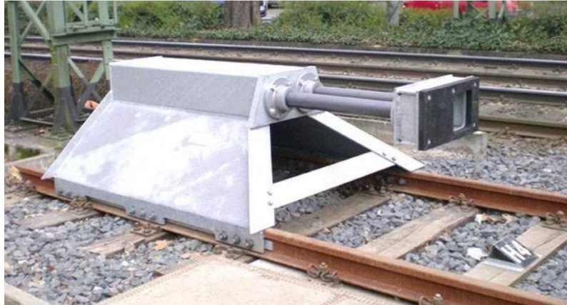
شکل ۱۰-۰ نمونه ای از بافر استاپ های ثابت با سیستم جاذب هیدرولیکی □
