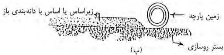
شکل ۴-۱۱ کاربرد زمین پارچه برای زهکشی زیرزمینی لایه‌های روسازی
