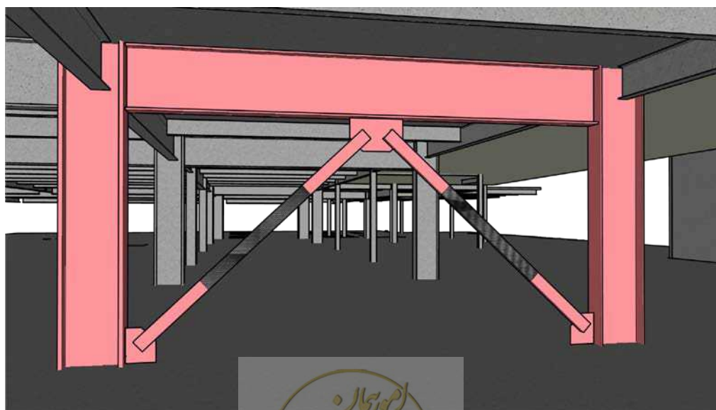
شکل ۱۴-۱۰۲- تقویت مهاربند با FRP
