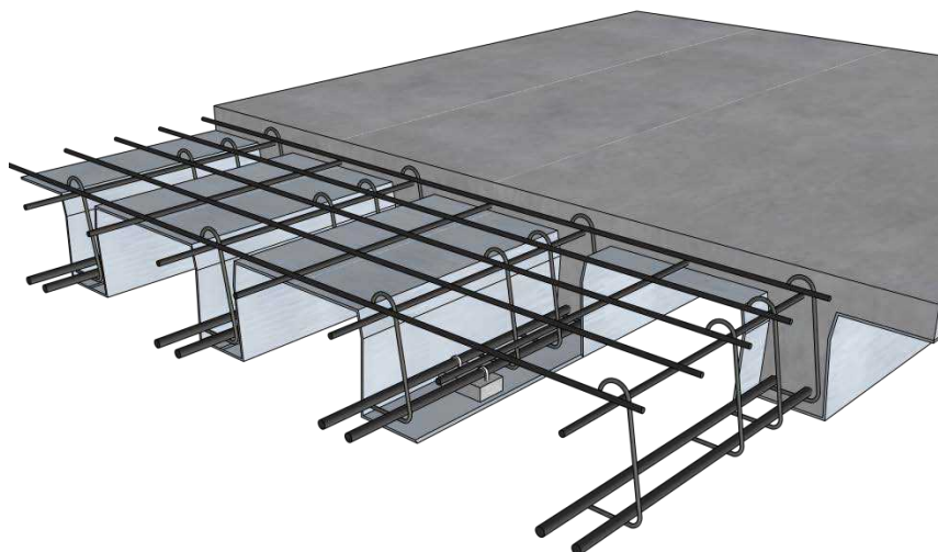
شکل ۶-۱۵- تصویر شماتیک از دال مجوف با تیرچه‌های یکطرفه
