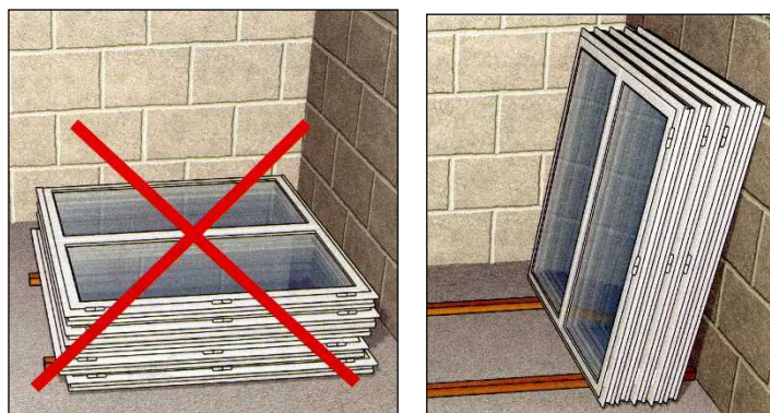
شکل ۱۲-۶۴- روش‌های درست و نادرست انبار کردن پنجره‌ها و درها
