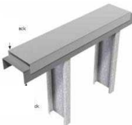
شکل ۱۱-۵- اجرای قاب سرد نوردشده نگهدارنده تخته‌گچی با دو تیرک به صورت کشویی
